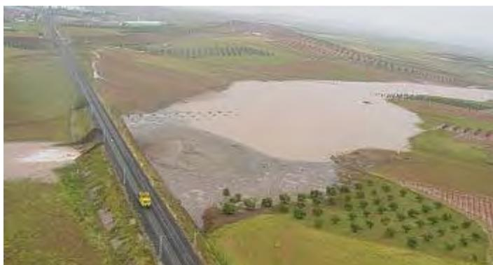
Figura 9. Vista aérea de las vías del tren que redujeron la capacidad de desagüe del cauce.
