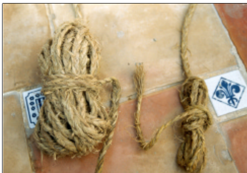
Fig. 2.73. Cuerda de esparto para el atado del cañizo a la estructura de cubierta y del cañizo entre si
