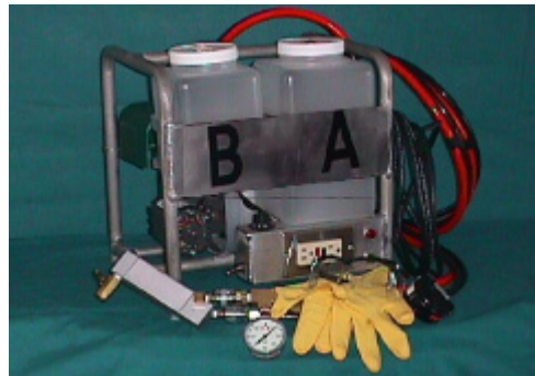
Fig. 4.27. Ejemplo de equipo de mezcla, y bomba de presión, para realizar inyecciones con un sistema epoxídico bi-componente
