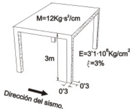
Fig. 3.21 Ejemplo 1. Cálculo del período propio de vibración de un pórtico de una planta de hormigón armado
